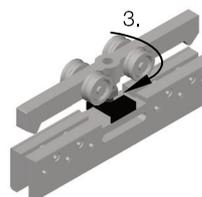
**5 Türhöhe mit unterer Schraube einstellen, dann mit oberer Mutter sichern**
