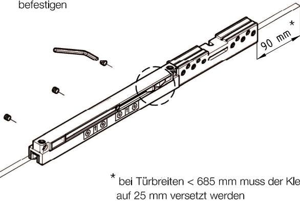
\* bei Türbreiten < 685 mm muss der Klemmbeschlag auf 25 mm versetzt werden
