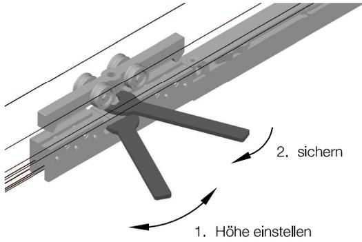
**6 Bodenführung montieren**
