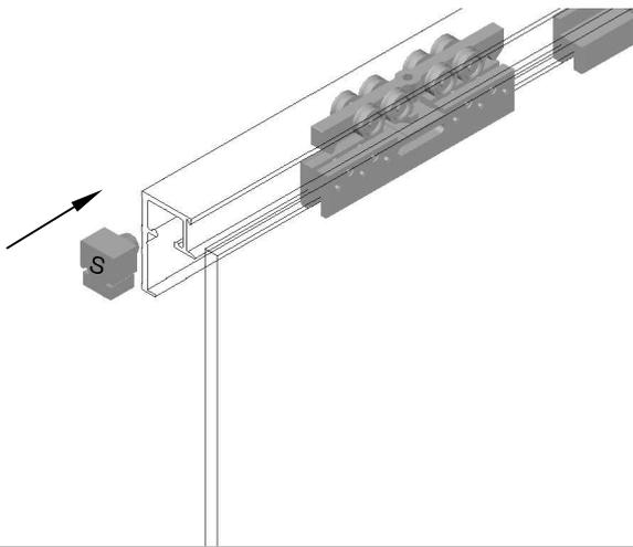
**8 Tür in die gewünschte Endposition bringen, Stopper entsprechend befestigen**
