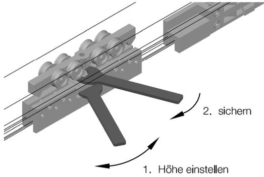
**6 Bodenführung montieren**
